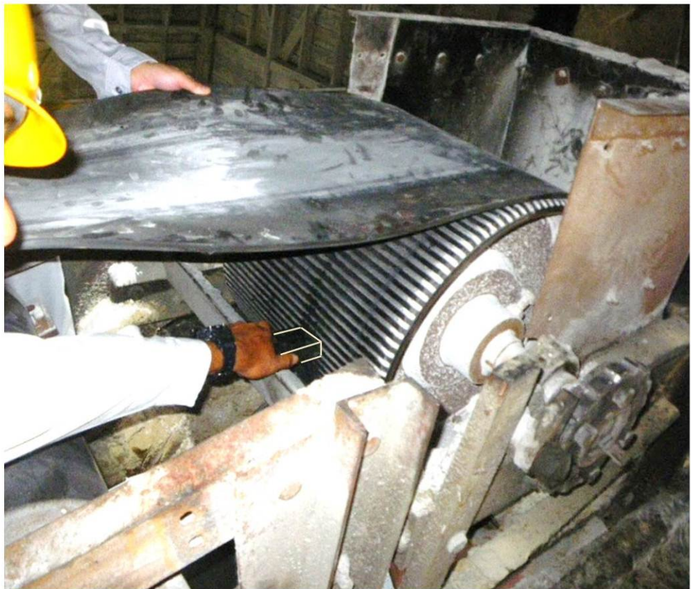
ヘッドプーリーへのベルトワックス塗布状況の再現(推定)
