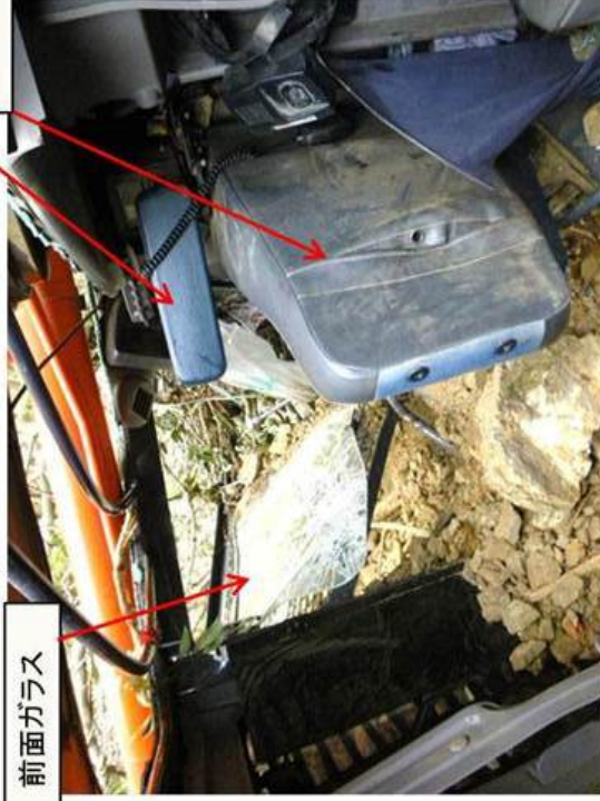
③ 転落した油圧ショベル キャビン内の状況
