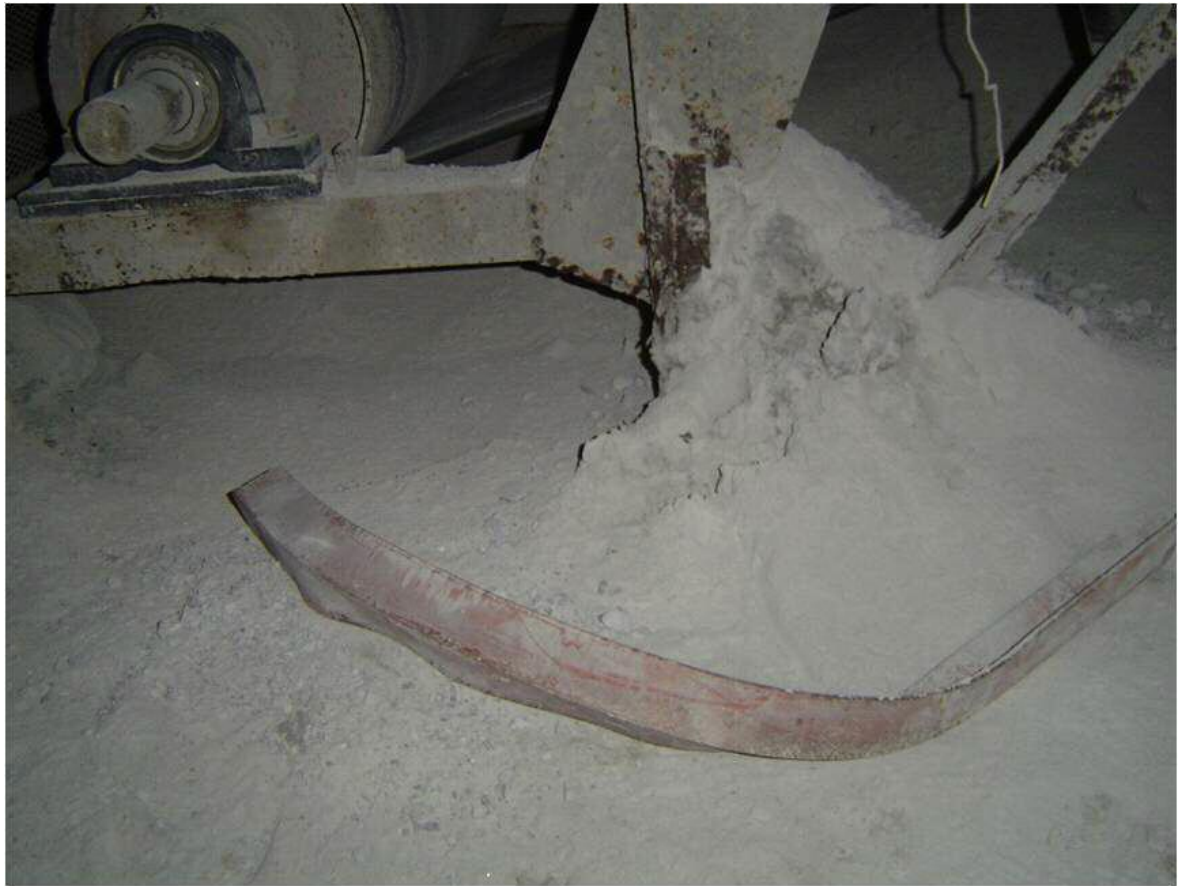
巻き込まれたL型アングル(50mm × 50mm × 1,040mm)
