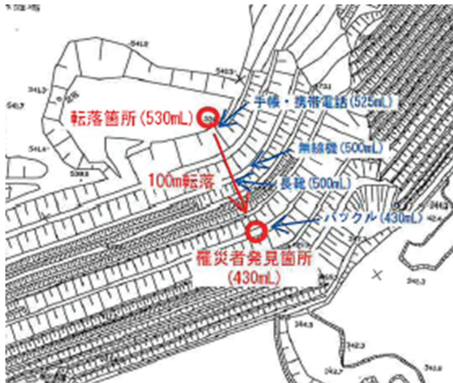
図1. 鉦山全景（上図）と転落推定箇所・発見箇所の拡大図（下図）
