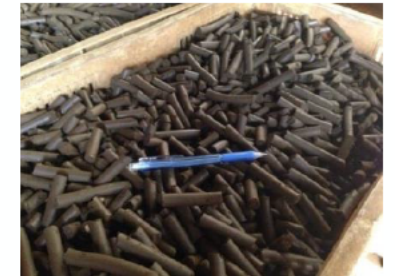
製造直後の脱硫化水素剤
