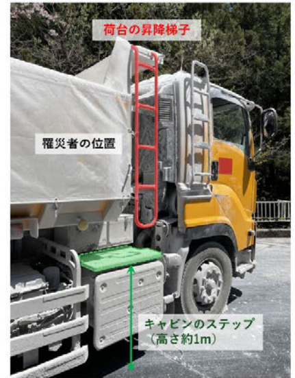
(写真2) 昇降梯子とキャビンステップ
