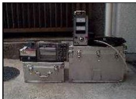
直流漏れ電流試験装置
