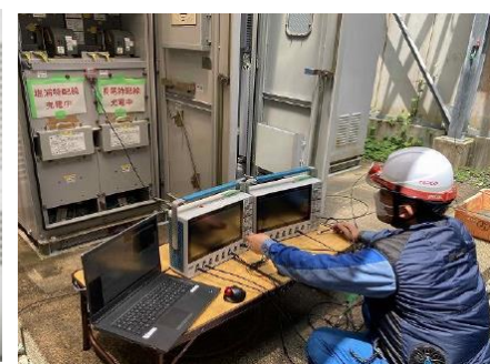
画像や測定器による機器劣化診断
