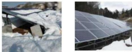
積雪による太陽電池発電設備の破損
