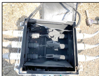
〔落雷による焼損〕 上：外観 下：内部
