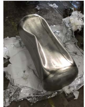
【試験による内槽の変形】
